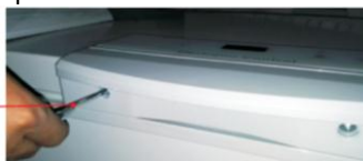
Закрепите ручку на двери с помощью винтов
